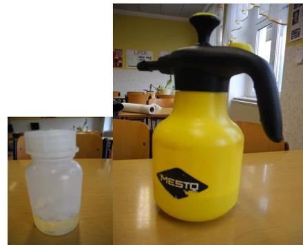
Kurz vor dem Ankleben der Folie die Scheibe mit Isopropanol-Alkohol reinigen, um Fettrückstände zu beseitigen. Dafür das Isopropanol aufsprühen und mit Haushaltsrolle trocken reiben. Insbesondere auch evtl. Dichtungslippen reinigen. Vorsicht bei Holzfenstern – der Alkohol kann die Beschichtung auflösen.
